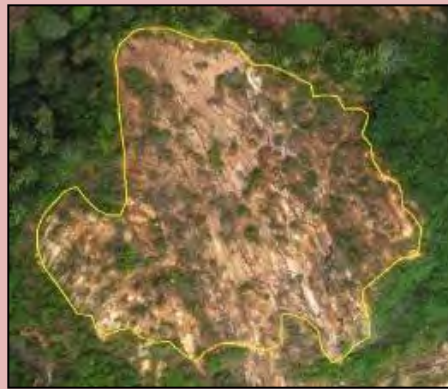
①斜面崩壊の検出
