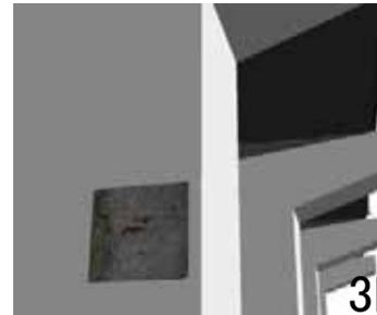
現在、点検結果はポンチ絵などに大まかに記録されている。3Dモデルにクラックの抽出結果をテクスチャとして貼り付け、定期点検によってクラックの進行を監視する。
