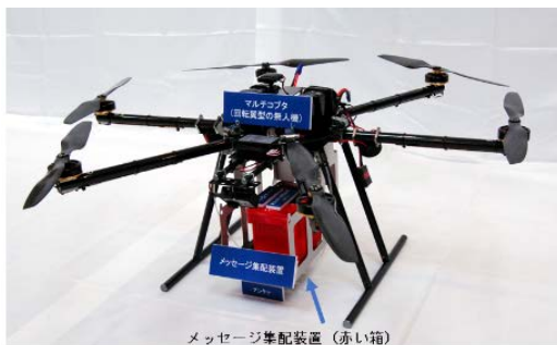
回転翼型無人航空機（マルチコプタ）に 実験の様子（孤立地域でのEメール送信搭載した「メッセージ集配装置」
